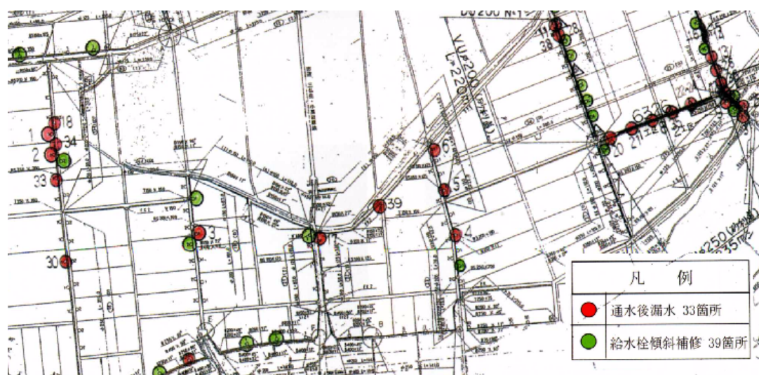
図 管路破損位置(赤丸は通水後に確認された場所)
