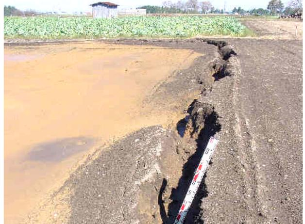
農地で生じた液状化／砂利採取後埋め戻した畑／平坦で、傾斜は 1/100 程度／04. 10. 29／小千谷市高梨町
