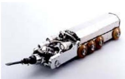
図 下水道探査ロボットの例
