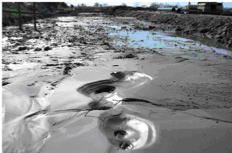
写真1 液状化による大量の噴砂
