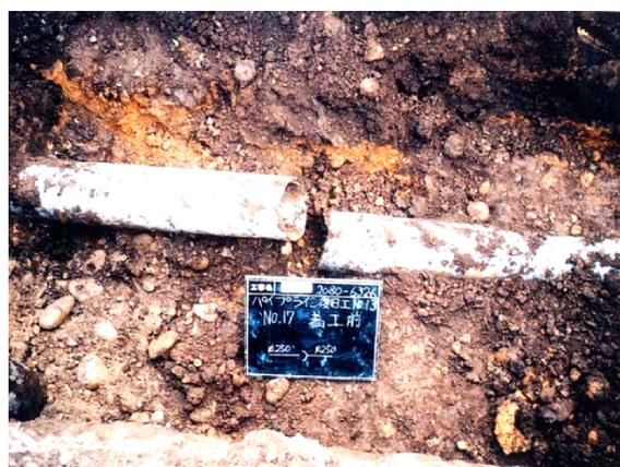
写真3 道路面下の管路の破壊
