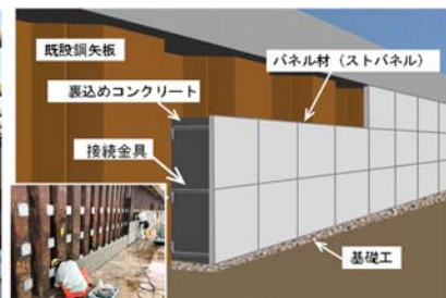
（ストパネ工法の概要図）
